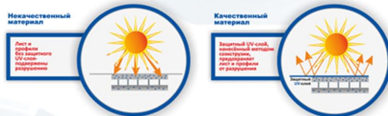
Схема воздействия солнечных лучей на лист сотового поликарбоната
